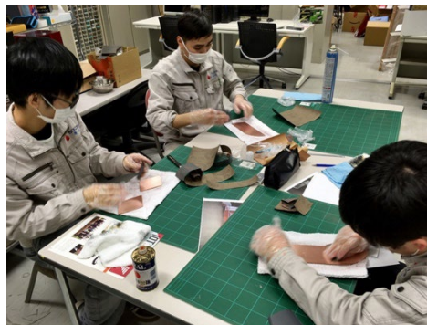
図 13 銅板の磨き作業
