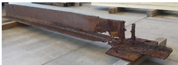
a)実橋鋼桁の腐食劣化部
