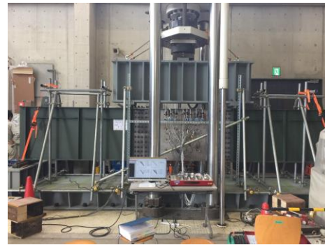
b) 鋼桁の CFRP 補強確認実験
