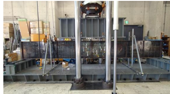
写真1 鋼桁の曲げ載荷実験の状況
