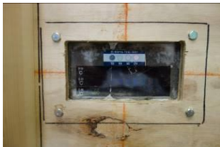
(e)せき板内側に貼付け
