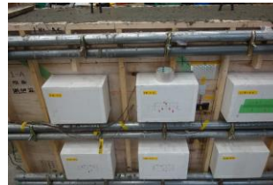
(c)ボス供試体断熱養生
